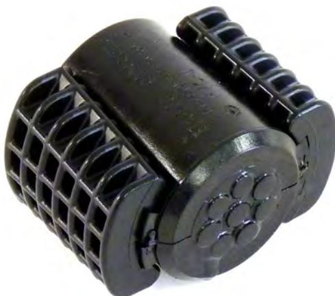
Les raccords d'étanchéité pour bundle de microtubes sont faciles à monter, sont divisibles, réutilisables et étanches au gaz et à l'eau jusqu'à 0,5 bars. Ils ont été conçus pour les bundle de microtubes avec et sans gaine extérieure. Grâce à ces pièces moulées il est possible d'étanchéifier et de fixer l'espace entre le conduit vide ou occupé et le microtube. Ils servent également à étanchéifier et fixer l'espace entre le bundle et les microtubes individuels.
