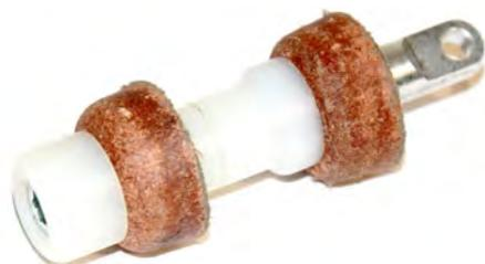
Le furet tire-fil est envoyé par air comprimé à l'intérieur du tube PE. Il possède une chape mâle grâce à laquelle un filin peut être attaché, permettant ainsi le tirage ou l'aiguillage.
