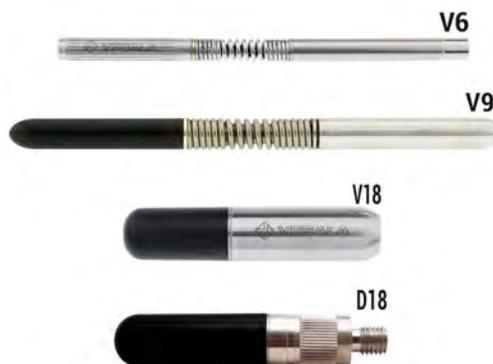
Les sondes sont de petits émetteurs autonomes alimentés par batterie. Les sondes sont insérées dans des fourreaux ou canalisations non métalliques et peuvent être localisées à la surface par un détecteur de sonde ou un détecteur de réseaux enterrés avec un mode sonde.
