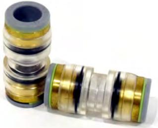
Les raccords droits pour microtubes offrent une mise en œuvre rapide et fiable. Prévus pour le portage de micro-câbles leur système "push in" assure une connexion / déconnexion simple tout en garantissant une forte tenue. Leur corps en plastique transparent permet de plus un contrôle visuel du passage de micro-câbles.
