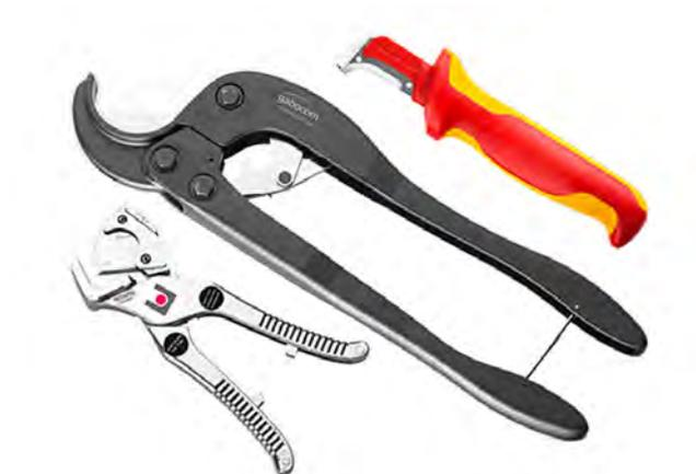
Grâce à cet outillage, il est possible de couper les microtubes et les bundles sans copeaux et à angle droit. Le dénudeur avec lame protectrice s'adapte particulièrement bien à l'ouverture de la gaine entourant nos ensembles de sous tubages. En effet le risque de blessure par rapport à l'utilisation d'un couteau est considérablement diminué.
