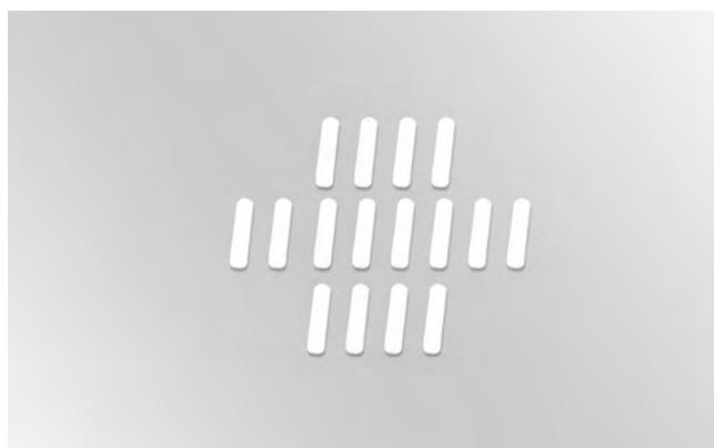
Les cylindres de calibrage permettent de vérifier le diamètre intérieur des microtubes, la présence d'aspérités résiduelles ou l'ovalisation éventuelle du tube dans les réseaux enterrés.
