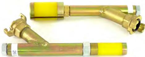
L'obturateur guide-fil permet l'aiguillage de la canalisation, il assure l'intermédiaire entre la compression et le furet, il garanti l'étanchéité du tube grâce au système de joint presse-étoupe. Il assure également l'obturation du tube et le soufflage de l'air comprimé dans le tube afin de porter le furet à l'intérieur.
