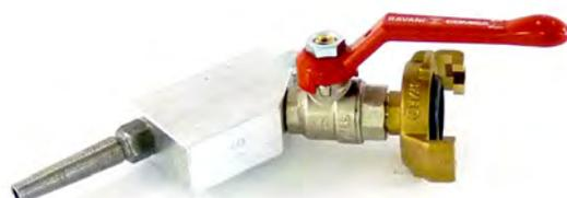
L'obturateur guide-fil permet l'aiguillage de la canalisation, il assure l'intermédiaire entre la compression et le furet, il garanti l'étanchéité du microtube grâce au système de joint presse-étoupe. Il assure également l'obturation du microtube et le soufflage de l'air comprimé dans le microtube afin de porter le furet à l'intérieur.
