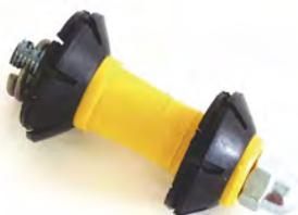
Ces furets sont envoyés par air ou par eau à l'intérieur des gaines LST/PVC non occupées. Ils possèdent un anneau d'accrochage grâce auquel il est possible d'attacher un fil permettant le tirage ou l'aiguillage. Un train de calibrage ou une boule mousse peuvent également être accrochés grâce à l'attache présent à l'arrière. L'utilisation de ces furets peut se faire sur des longueurs allant jusqu'à 600m.
