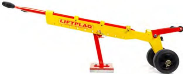
Conçu pour faciliter les manipulations de plaques télécom et tampons de voirie, le Liftplaq est doté d'un aimant surpuissant qui adhère à la paroi métallique et maintient la préhension lors du levage. Le matériel, muni d'un bras articulé, réduit l'effort par trois. Il épargne ainsi les maux de dos, incitant à fléchir les jambes plutôt qu'à forcer pour soulever les plaques.
