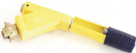
Composé d'une crosse en plastique, d'un obturbateur réglable et d'un raccord tête de chat, l'obturateur guide-fil permet d'aiguiller à l'aide d'un compresseur jusqu'à 1 000 m d'un seul tenant.
