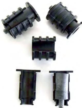
Les raccords d'étanchéité divisibles et résistants à la traction sont réutilisables et adaptés à l'étanchéification des microtubes. Ils sont étanches au gaz et à l'eau jusqu'à 0,5 bars, et sont munis d'une protection anti-pliage pour les câbles en fibre optique. La soupape de sécurité intégrée s'ouvre avant qu'une pression de soufflage de 10 bars soit atteinte. Les pièces moulées sont simples et rapides à monter sans outillage spécialisé.
