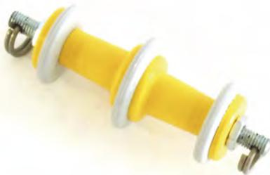
Les trains de calibrage permettent de vérifier et qualifier le diamètre intérieur et l'absence d'ovalisation des gaines LST/PVC. Ils peuvent être couplés aux furets tire-fil afin de réaliser les opérations de calibrage et d'aiguillage.
