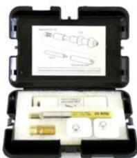
Si le furet de calibrage reste bloqué à l'intérieur du tube PEHD, la sonde est alors envoyée dans le tube pour localiser le furet et ainsi déterminer où l'intervention de déblocage doit avoir lieu, grâce à un système de détection.
