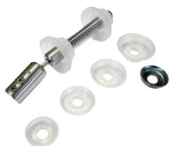
Le « Furet parachute » permet d'améliorer le soufflage d'un câble de 32, 40 ou 50 mm dans des tubes PEHD. Il va accumuler la pression d'air à l'entrée du câble, et ainsi améliorer les longueurs de soufflage.
