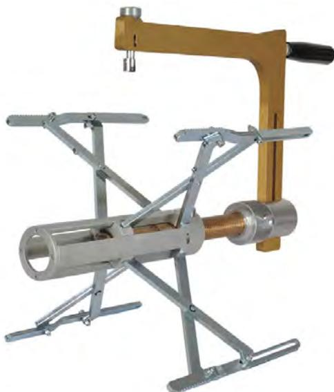
Les racleurs de tubes orbitaux professionnels indispensables à la préparation de raccords et de tubes en Polyéthylène (PE-AD, PE-X) et Polypropylène (PP, PP-R) avant électrofusion sont composés d'une broche réglable pour couvrir tous les diamètres inclus dans la plage de travail et d'un bras porte-lame orbital.
