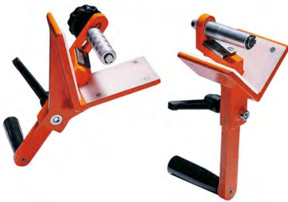
Outils professionnels pour chanfreiner jusqu'à Ø 315 mm des extrémités de tubes à insérer dans des manchons ou des raccords. La conformation spéciale des lames et le revêtement antiadhésif (PTFE) des parois permettent un traitement facile et rapide du tube. Pour tubes en PE, PP, PB, PVDF, PVC.
