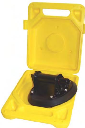
La pompe à vide, située dans la poignée, est actionnée par pressions successives sur le piston. Un clapet casse-vide permet de libérer la ventouse.
