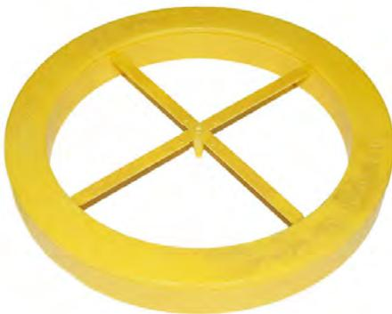
Le disque marqueur est un marqueur électrique passif, utilisé pour le marquage des points significatifs d'un réseau enterré. Les marqueurs sont enterrés au dessus de la canalisation, soit lors de la pose du réseau, soit à l'occasion de travaux de réparation. Ils peuvent être détectés aisément, même après plusieurs années.
