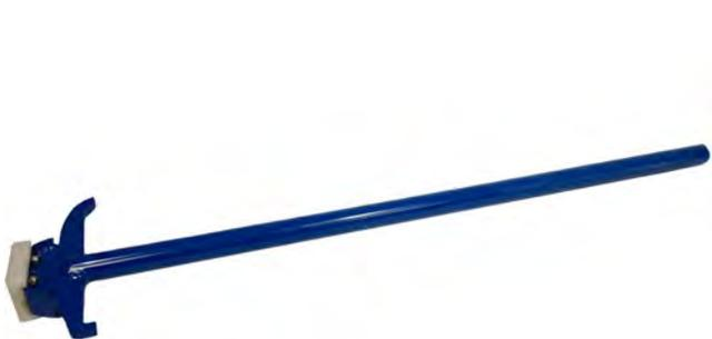
A l'ouverture des chambres, le marteau lève-plaque permet de décoller les plaques en frappant en leur milieu grâce à sa semelle, de soulever et déplacer les plaques grâce à la pointe ou le crochet du marteau se plaçant dans les encoches de la plaque prévues à cet effet.
