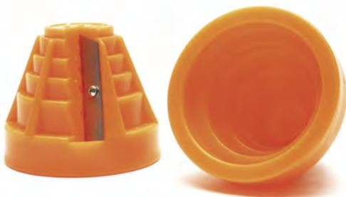
Ebavureur taille-crayon pour tube PEHD. Il permet de s'adapter à différents diamètres de tube, allant jusqu'à 63 mm. Sa lame inoxydable lui confère des propriétés de coupe permettant d'ébavurer vos tubes proprement. Enfin, son corps en polypropylène lui permet de résister aux chocs et au froid.
