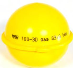
Les boules marqueurs constituent une solution innovante pour marquer et localiser les réseaux enterrés. A la différence des marqueurs standards utilisant un seul circuit, il contient 3 circuits orthogonaux et résonants. Quand ils sont excités par un détecteur, ces circuits produisent un champ électromagnétique uniforme et sphérique dans chaque direction.
