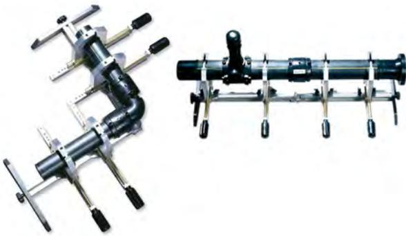
ALIGNEUR UNIVERSEL 160 Light, équipement professionnel indispensable pour maintenir les tubes bloqués et alignés lors du soudage de manchons électriques de Ø 63 à Ø 160 mm.
