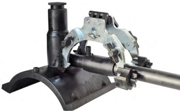
Positionneur universel compact pour travailler en place sur tubes, raccords et colliers de prise. La géométrie spéciale des mâchoires permet une fixation en ligne, à 45° et 90°.
