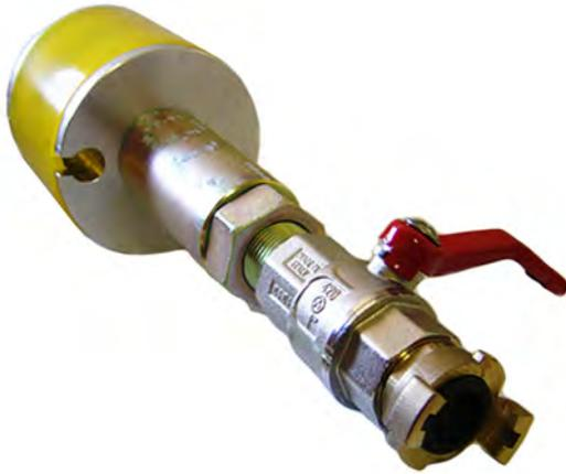
Les obturateurs guide-fils permettent l'aiguillage d'une canalisation. L'extrémité du pistolet assure l'étanchéité au niveau de la conduite. La partie latérale intègre un passage pour la ficelle d'aiguillage qui sera attachée au furet dans la conduite. Couplé à un compresseur, le dispositif permet de propulser le furet dans la conduite, assurant le déploiement de la ficelle d'aiguillage.
