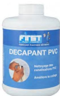
Le décapant PVC est utilisé en application primaire pour la préparation du collage (soudure à froid). Le décapant par son action chimique va ramollir la matière PVC et permettre une accroche fiable de la colle. Il permet également de préparer la surface en supprimant les traces grasses pouvant se trouver sur le tube et le raccord résultant de leur extrusion et injection.
