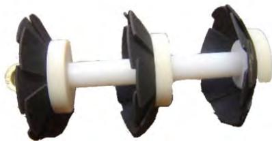
Les furets sont envoyés par air comprimé à l'intérieur des conduites. Chaque furet possède un anneau d'accrochage grâce auquel on peut attacher un filin permettant le tirage ou l'aiguillage. Un mandrin de calibrage ou une boule mousse peuvent également être accrochés. L'utilisation du furet peut se faire sur des longueurs jusqu'à 600m.
