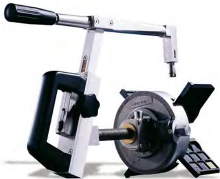
Pratiques et faciles à manipuler, ils sont indispensables dans la préparation des tuyaux et raccords en plastique qui doivent être soudés avec des manchons électriques. Le grattage est nécessaire afin d'éliminer la couche d'oxydation créée à la surface du tuyau / raccord due aux agents atmosphériques et aux rayons ultraviolets (UV); sinon éliminée, cette oxydation compromet totalement ou partiellement le soudage.
