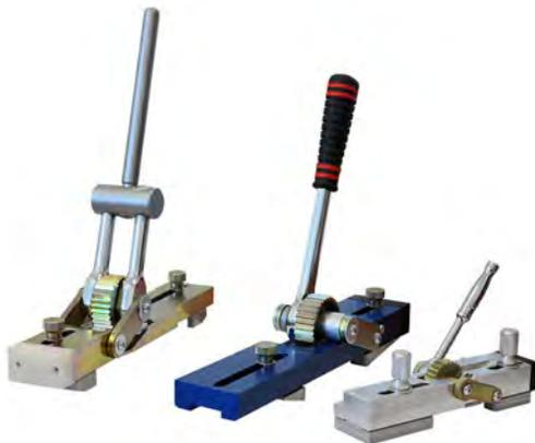
L'outil enlèvera la bride extérieure qui se forme sur le tuyau lors d'une soudure bout à bout.
