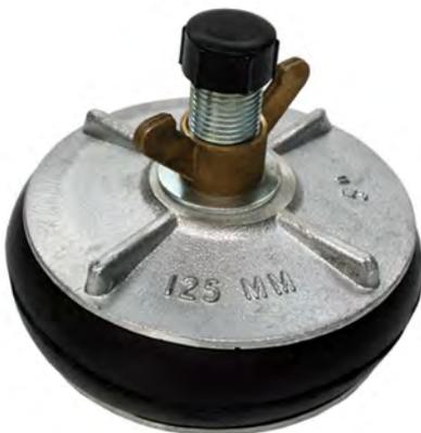
L'obturateur DTP se compose de deux plaques en aluminium, d'un profil élastomère pris en sandwich entre les deux plaques, d'une vis creuse et d'un écrou type banjo.
