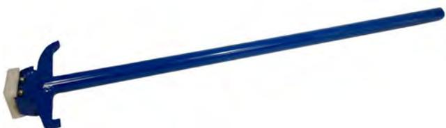
A l'ouverture des chambres, le marteau lève-plaque permet de décoller les plaques en frappant en leur milieu grâce à sa semelle, de soulever et déplacer les plaques grâce à la pointe ou le crochet du marteau se plaçant dans les encoches de la plaque prévues à cet effet.
