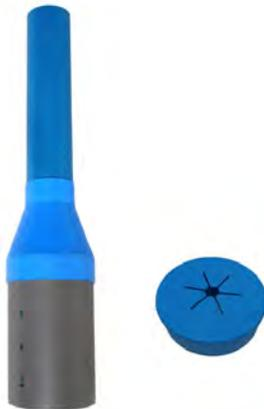
Le tube cloche pour vanne permet de se raccorder aux vannes de prise en charge par le dessus. Il convient de placer le centreur en le clipsant sur le carré de manoeuvre puis de positionner le tube cloche. La matière des tubes lui confère longévité et résistance aux chocs, cependant, nous vous conseillons de stocker les produits à l'abri des U.V.
