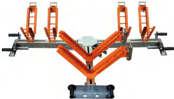
ALIGNEUR UNIVERSAL 125-500 est un outil professionnel indispensable pour le positionnement et le support de tuyaux lors du soudage de manchons électriques de Ø 125 à 500 mm.
