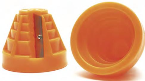
Ebavureur taille-crayon pour tube PEHD. Il permet de s'adapter à différents diamètres de tube, allant jusqu'à 63 mm. Sa lame inoxydable lui confère des propriétés de coupe permettant d'ébavurer vos tubes proprement. Enfin, son corps en polypropylène lui permet de résister aux chocs et au froid.
